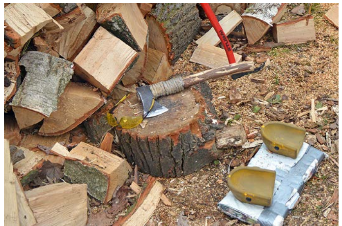
Die Ausrüstung zum Hacken besteht aus Knieschonern, einem Polster, Schutzbrille, einem Beil sowie einem Sappie zum Beiziehen der Stücke. Als Hauklotz bevorzugt Dirk Lings möglichst niedriges Holz, am besten dünne Scheiben aus einer Astgabel, die auch unter hoher Belastung nur schwer brechen.
