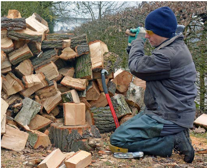
Der Hauklotz ist nicht besonders hoch, damit Dirk Lings das Holz nur wenig anheben muß. Zum Schwungholen legt er das Beil auf die Schulter und schlägt mit beiden Händen zu. Dieser kurze Weg reicht meistens aus, um das frische Holz mit dem ersten Schlag zu spalten. Fotos: Riemann
